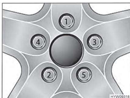
Bild 127 Radmuttern oder Radschrauben über Kreuz festziehen
